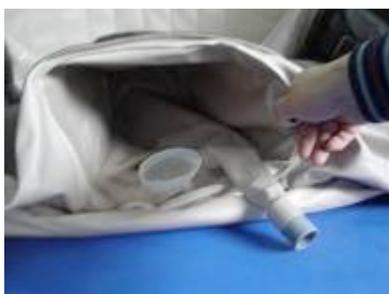
Aplatir le tuyau avant de mettre le tableau de commande.
