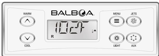
Certains boutons ont des boutons séparés CHAUD (Haut) et FROID (Bas), alors que d'autres ont un simple bouton **Température**. Dans le diagramme de Navigation, les boutons Température sont indiqués par un icône de bouton unique. Les panneaux avec les deux boutons (Chaud et Froid) peuvent utiliser les deux pour simplifier la navigation et la programmation ou l'unique Icône de Température est affiché.
