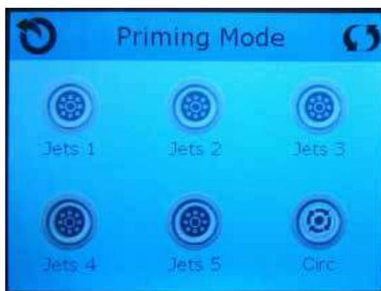
Important: Une pompe ne doit pas être autorisée à fonctionner sans amorçage plus de 2 minutes. Sous AUCUNE circonstance une pompe devrait être autorisée à fonctionner sans amorçage au-delà de la fin des 4-5 minutes du mode d'amorçage. Cela pourrait entraîner des dégâts à la pompe et provoquer l'enclenchement du réchauffeur et entraîner une surchauffe.
